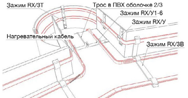
Рис. 4 (Крепление нагревательного кабеля возле водосточной воронки)
